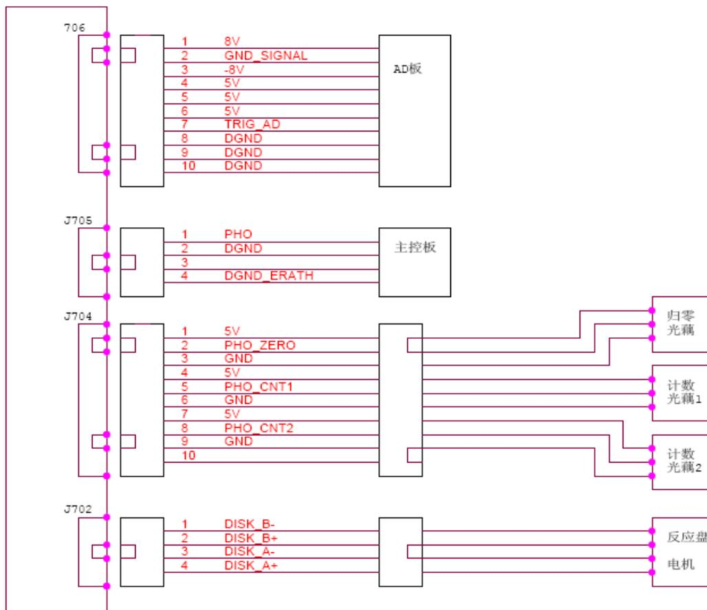
反应盘电机连线图
