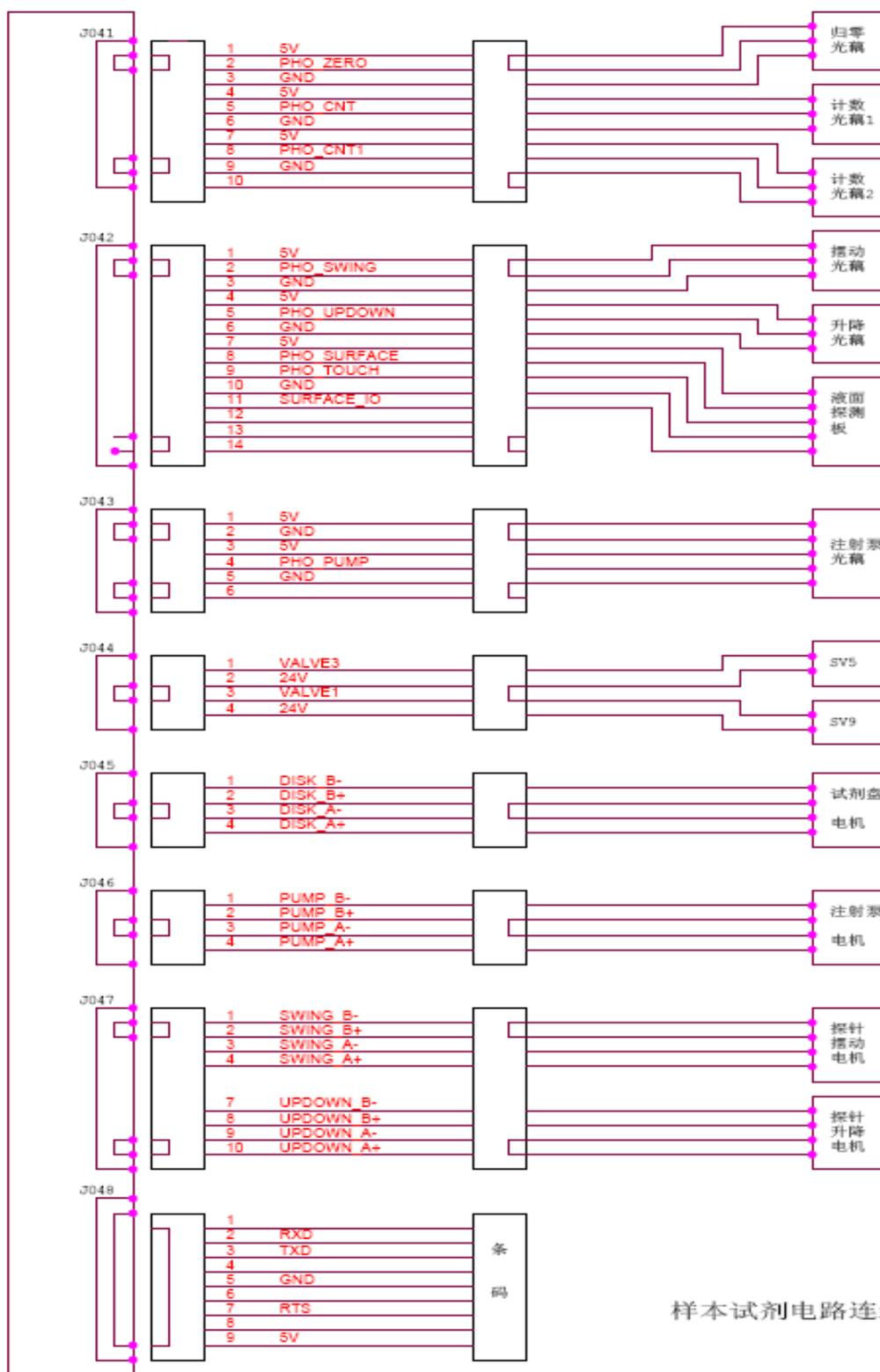
样本试剂电路连线图
